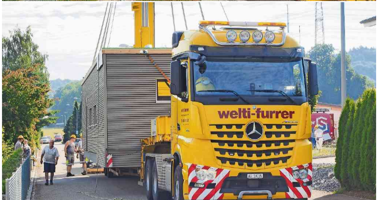
Mit Kran und Seilen wird das 22 Tonnen schwere Kleinhaus auf den Lastwagen gehoben und nach Wolfwil transportiert.
